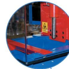
Piano di appoggio mobile con sistema a cremagliera per facilitare il posizionamento del pneumatico da parte dell'operatore.
