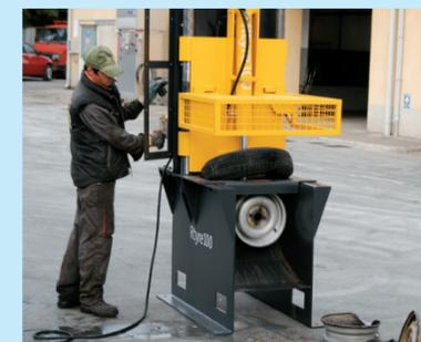
Protezione in materiale antiurto lexan, completamente trasparente per permettere all'operatore la massima visibilità; la protezione si alza e si abbassa automaticamente durante le fasi del ciclo.
